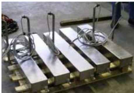
3 Foto: trasduttori ad immersione diretta e trasduttori saldati su grandi impianti di lavaggio metalli e superfici di precisione.
