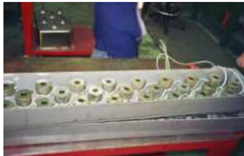
3 Foto: trasduttori ad immersione diretta e trasduttori saldati su grandi impianti di lavaggio metalli e superfici di precisione.
