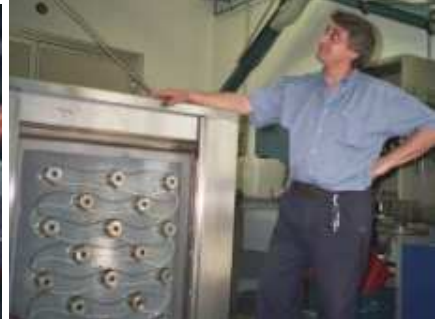
3 Foto: trasduttori ad immersione diretta e trasduttori saldati su grandi impianti di lavaggio metalli e superfici di precisione.
